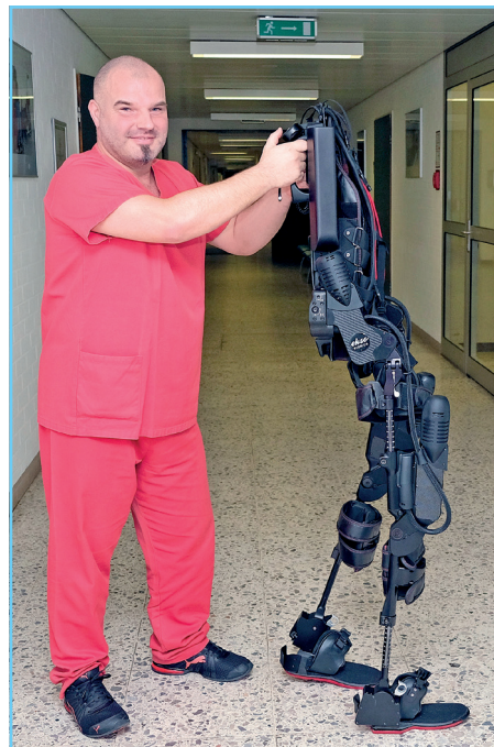
Jochen Gradwohl demonstriert die Funktionsweise des Exoskeletts. Ist es eingeschaltet, bewegt es sich wie ein Mensch. Der Patient, dem das Exoskelett angezogen wurde, kann dann trotz Lähmung laufen.
